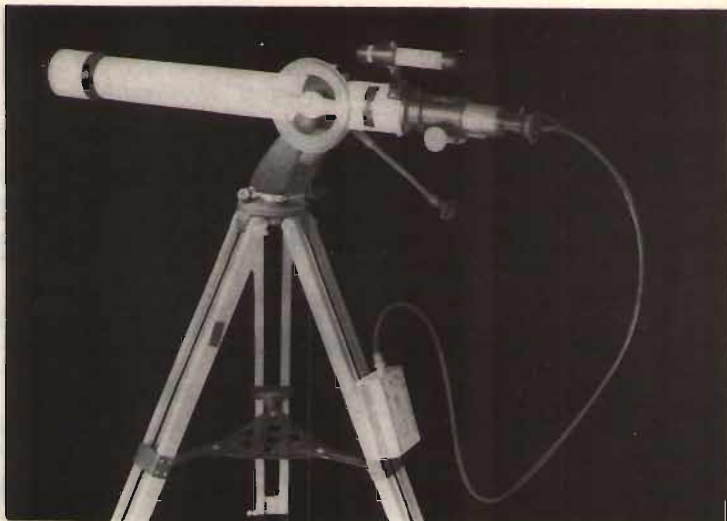
Il ricevitore I.R. Beta Geminorum collegato all'ottica del telescopio.
